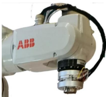
图 2-2 末端执行器连接后的效果
